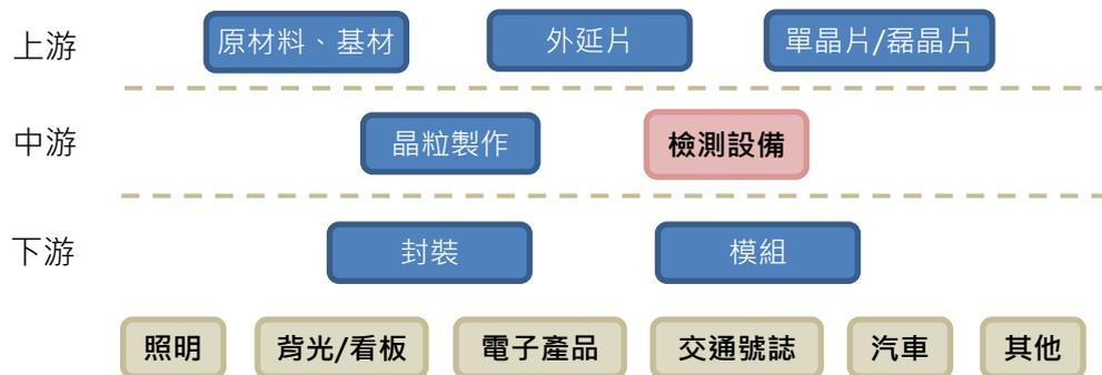
LED 的製程可用上、中、下游三階段來說明，上游是生產 LED 原材料，如單晶棒、單晶圓及磊晶片，中游是在磊晶片上加工，進行金屬蒸鍍、蝕刻、電極製作，經測試後進行晶粒切割及挑選，最後是下游的封裝及模組程序，依終端應用市場需求包裝成各種成品。本公司所研發、製造生產的光電半導體自動化設備係提供中游廠商在完成 LED 製程，於晶粒切割前與切割後的晶圓與晶粒點測(Probe)、光電量測(Test)及晶粒分類之自動化平台，由於 LED 的晶粒尺寸小，一片 2~4 吋的晶圓即會有數萬顆的晶粒，因此其檢測所需的時間長，相對測試機台的需求及依賴度也大。本公司生產之光電半導體自動化設備，將點測及光電量測等功能整合，有效提升檢測設備之效能及效率，為業界首創。
